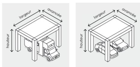
\*À partir d'une largeur ou d'une avancée de 4500 mm, le carport dispose d'une poutre intermédiaire.
