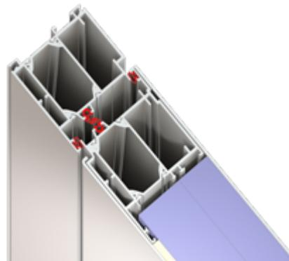
Ouvrant et dormant avec 3 barrières de joints pour une isolation performante.
